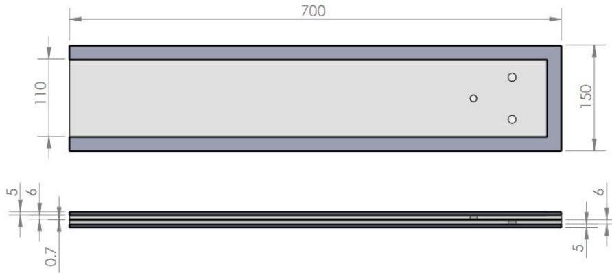
Figura 17: Dimensões da célula de Hele-Shaw em milímetros.
