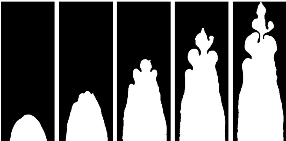
Figura 38: Escoamento para \bar{u}^*=31,337 e \eta^*=0,045 . Goma xantana 0,86% deslocando óleo mineral a 25°C e 680,92 g/min.
