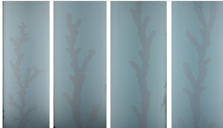
Figura 9: Água deslocando Carbopol 0,10% nas respectivas vazões em [g/min]: 2, 48, 13, 15, 23, 81 e 50,48.
