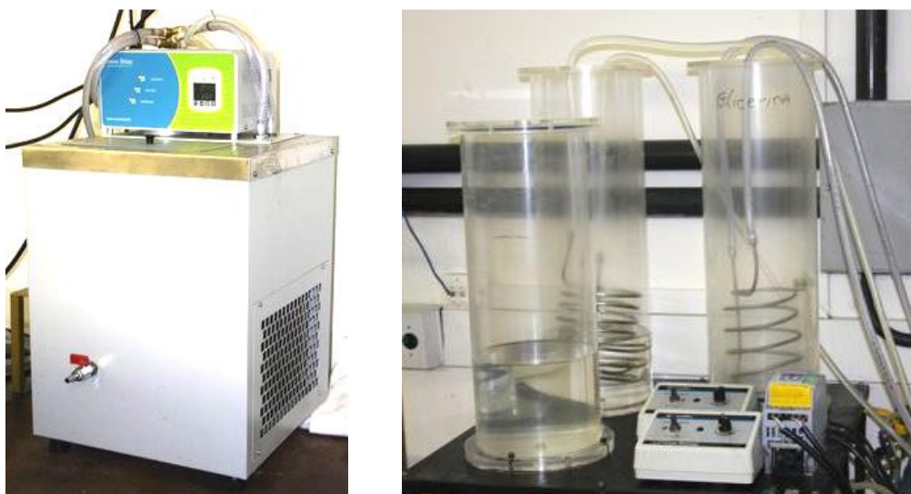
Figura 28: Sistema de controle de temperatura do fluido newtoniano.
